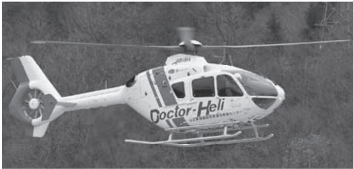
今回、公立豊岡病院に配備されたドクターヘリは、EC135フェネストロンと呼ばれる機体です。この機体の特徴は、尾部ローターがむき出しではなく、機体に埋め込まれている所にあります。これにより、患者収容の際の安全性と騒音に配慮された構造となっていてコンパクトなデザインは、ドクターヘリに最適なキャビンで欧米では広く採用され、高い評価を受けています。
